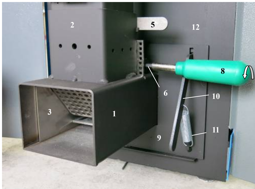
Рисунок 4 - Пеллетная горелка в котле
